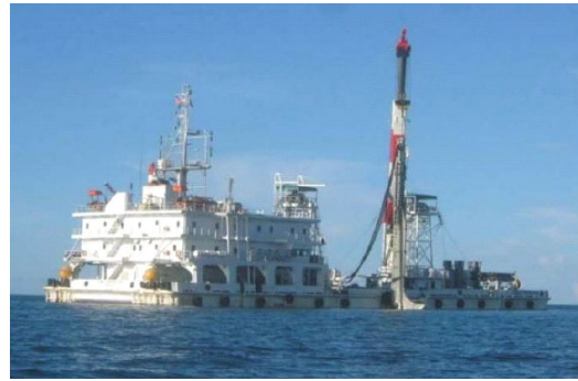
使用沖噴式掩埋工具的典型鋪纜躉船／船隻
