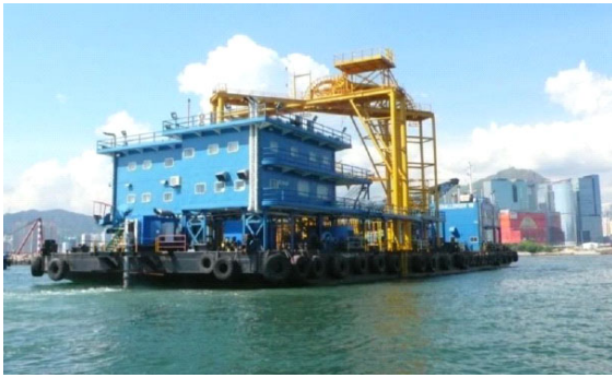
使用沖噴式掩埋工具的典型鋪纜躉船／船隻
